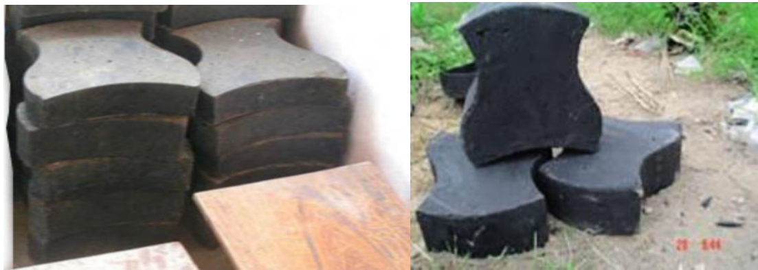
Figure 9 : Photographies de pavés produits à partir de plastiques recyclés
